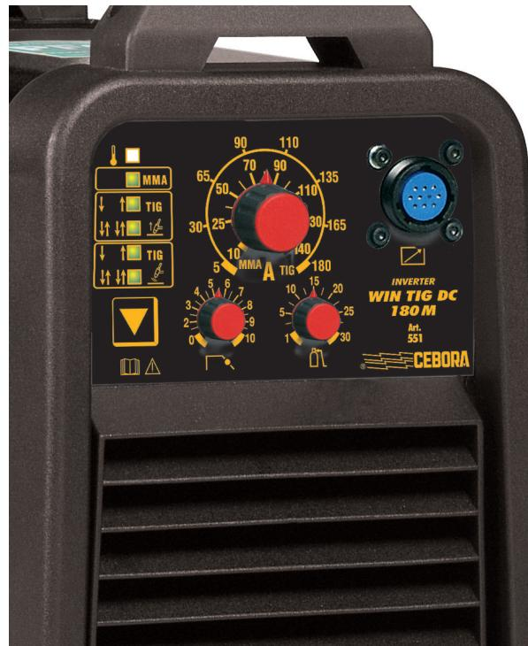
**WIN TIG DC 180 M (art. 551)** è un generatore monofase con tecnologia ad inverter (**180 A 35%**) per la saldatura TIG e MMA/SMAW ad esclusione degli elettrodi cellulosici AWS6010; principalmente destinato ai lavori di manutenzione e riparazione, nonchè per piccola produzione.
